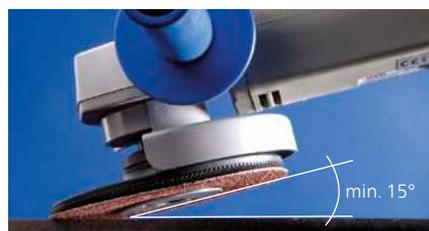
En comparaison, l'angle de travail des disques en fibre est nettement plus raide.
