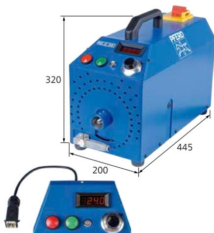
Machine à transmission flexible électronique avec raccord de transmission flexible DIN 10, très faible niveau sonore, courant alternatif triphasé et puissance d'entraînement élevée, y compris à basse vitesse. Atteint une vitesse maximale de 24 000 tr/min.
