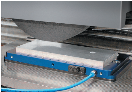
Rectification de métaux non ferreux. Vacmagic-100 monté sur table magnétique.
