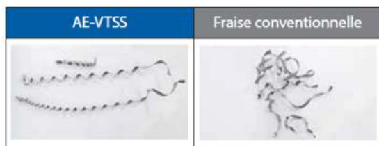
Forme des copeaux lors de fraisage en plongé Matière : INOX 304
