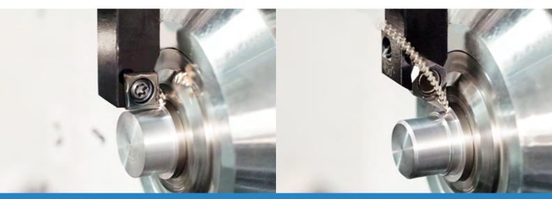
Introduction du PR1535 pour une durée de vie plus longue et un usinage stable de l'acier inoxydable
