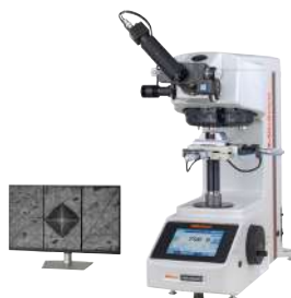
Système de caméra HDMI Vickers (A utiliser avec un testeur de dureté manuel Vickers) La caméra HDMI et l'écran permettent l'observation et la mesure des entailles à fort grossissement, réduisant ainsi l'erreur de l'opérateur. De plus, les images peuvent être stockées sur la carte SD de 16 GB comprises. Pas de PC nécessaire, avec câble HDMI et souris sans fil. A commander 63AAA356, 11AAC729 et NEC EA21N pour ensemble complet.
