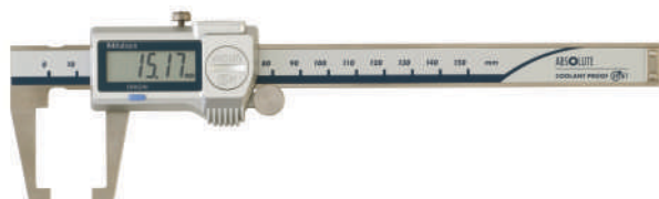
573-651-20 avec becs intérieurs pour mesurer l'épaisseur des parois
