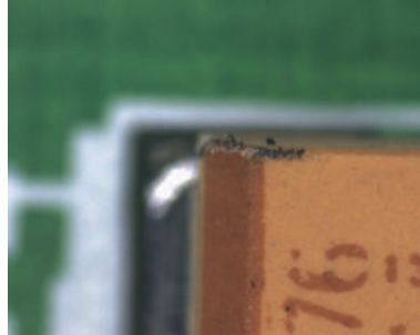
Observation standard au microscope normal (supérieur). Avec une différence de hauteur, la mise au point peut se faire uniquement sur le plan supérieur ou inférieur.
