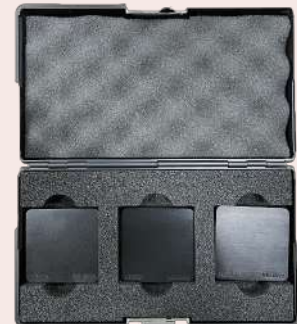
218000MIT Coffret de 3 étalons dureté Shore A 35,60, 85. Echelle de dureté 0-100 Shore A. Capacité de mesure 10-90 Shore A.
