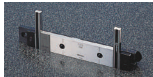
Support B et C : Permettent de maintenir en contact deux cales parallèles de grande longueur avec d'autres cales parallèles jusqu'à 35 mm (support B) ou 140 mm (support C). Permettent également de solidariser un bec avec deux adaptateurs. Support B : 619032 (R max.= 90 mm- L= 126 mm) Support C : 619033 (R max.= 200 mm- L= 236 mm)
