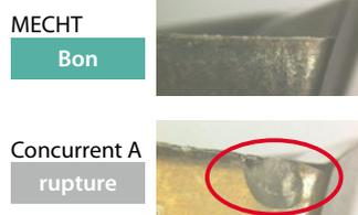
Conditions de coupe :  $V_c = 40$  m/min,  $ap \times ae = 43 \times 20$  mm,  $f_z = 0,12$  mm/t,  $\phi 50$  (5 dents), avec arrosage (liquide de refroidissement externe et interne), pièce à usiner : Machine Ti6Al4V : BT50
