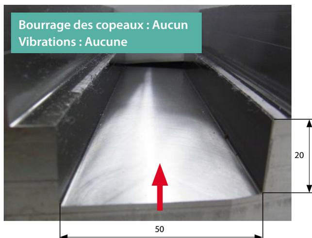
Conditions de réduction :  $V_c = 40$  m/min,  $ap \times ae = 20 \times 50$  mm (Rainurage),  $f_z = 0,08$  mm/t  $\phi 50$  (5 dents), arrosage au centre, pièce à usiner : Ti6Al4V Machine: BT50
