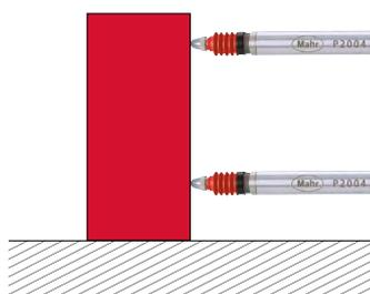
Contrôle de concentricité sur 2 diamètres d'arbre
