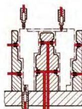
Mesures intérieures et extérieures multiples avec buses de mesure et palpeurs de mesure de contact en lien avec une colonne de filtrage.
