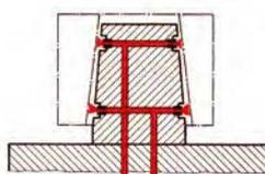
Mesure de conicité d'un cône intérieur avec tampon à buses coniques – Mesure selon la méthode différentielle
