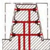
Mesure de conicité et mesure de forme et de diamètre d'un cône intérieur avec tampon à buse conique
