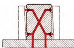
Mesure de la perpendicularité d'un alésage cylindrique par rapport à la face frontale avec tampon pneumatique à buse spéciale – Mesure selon la méthode différentielle
