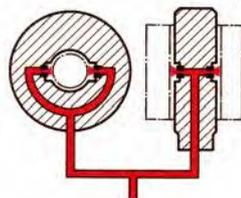
Mesure appairage entre alésage et arbre avec tampon pneumatique à buses et bague pneumatique à buses
