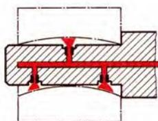
Mesure de rectitude d'un alésage cylindrique avec tampon pneumatique à buse spéciale
