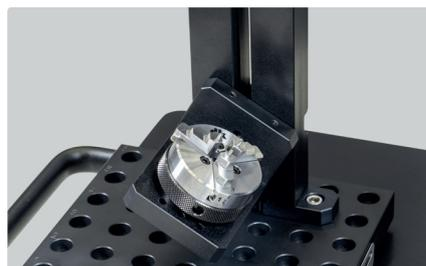
Avec les dispositifs de serrage standard, le support de dispositifs de serrage assure un positionnement flexible de votre pièce.
