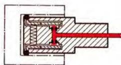
Mesure du diamètre des alésages borgnes cylindriques avec tampon pneumatique de contact à levier
