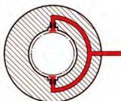
Mesure de diamètre ou d'épaisseur avec mâchoires pneumatiques réglables à buses
