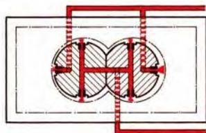
Mesure d'écartement d'alésages cylindriques entamés avec tampons pneumatiques à buses – Mesure selon la méthode différentielle
