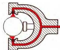
Mesure du diamètre d'arbres cylindriques avec bague pneumatique à buses
