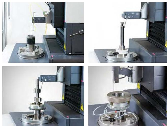
La machine **MarForm MFU 200** est déjà prête à l'utilisation des capteurs optiques, MarForm IPS, et peut ainsi mesurer avec haute précision des microstructures de surface.
