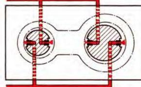
Mesure d'écartement d'alésages cylindriques séparés avec tampons pneumatiques à buses – Mesure selon la méthode différentielle
