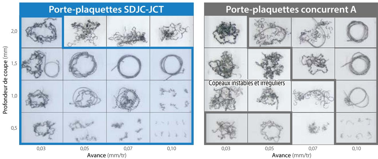
Conditions de coupe :  $V_c = 80$  m/min, DCGT11T302MP-CK PR1535 (les mêmes plaquettes ont été utilisées) Pièce : TAB6400 (Ti-6Al-4V) Arrosage externe et interne (1,5 MPa) Tournage
