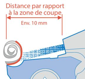
Comparaison de l'écoulement du liquide d'arrosage
