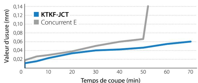
Conditions de coupe : Vc = 100 m/min, f = 0,02 mm/tr, sous arrosage (avec liquide de coupe à base d'huile)
