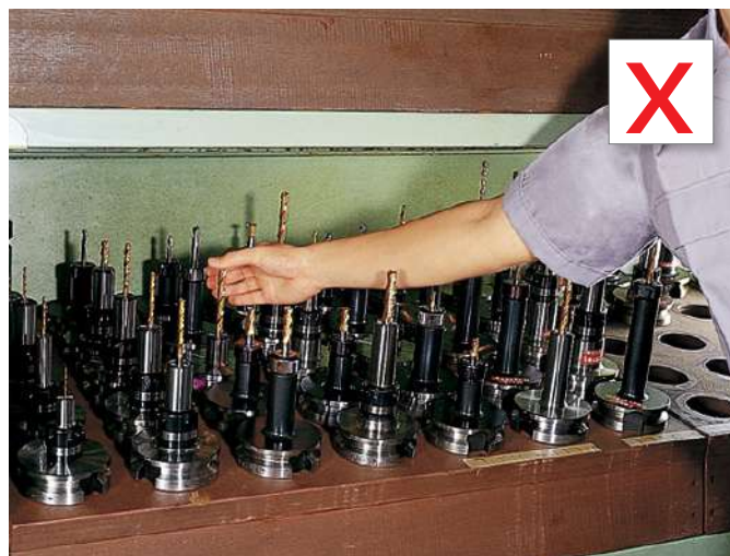
Avant : risque de blessure
