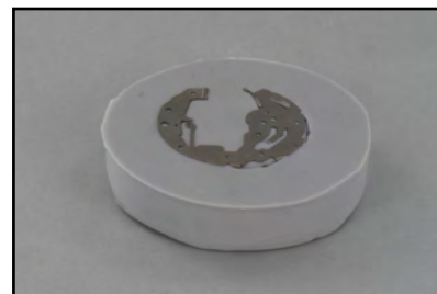
Posage sur mesure en M70 d'une pièce d'horlogerie.
