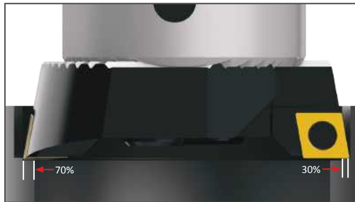
Enlèvement de matière jusqu'à 7,00 mm - 10,00 mm au diamètre : 70% ébauche 30% finition
