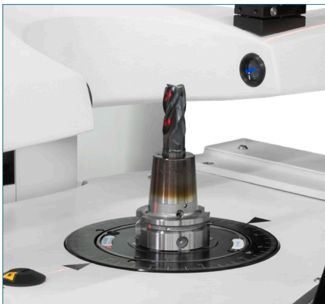
Mesure sans contact avec caméra haute résolution et traitement des images numériques, logiciel de mesure « Microvision » inclus
