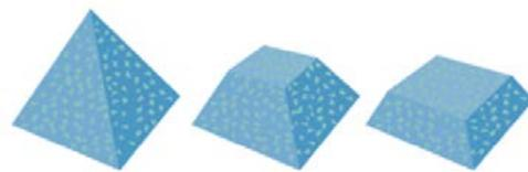
Les structures tridimensionnelles des abrasifs 3M™ Trizact™ contiennent plusieurs couches de minéraux. À mesure que ces structures s'usent, les minéraux sont de plus en plus exposés à la pièce, assurant une coupe plus rapide et cohérente pendant toute la durée d'utilisation de la bande.
