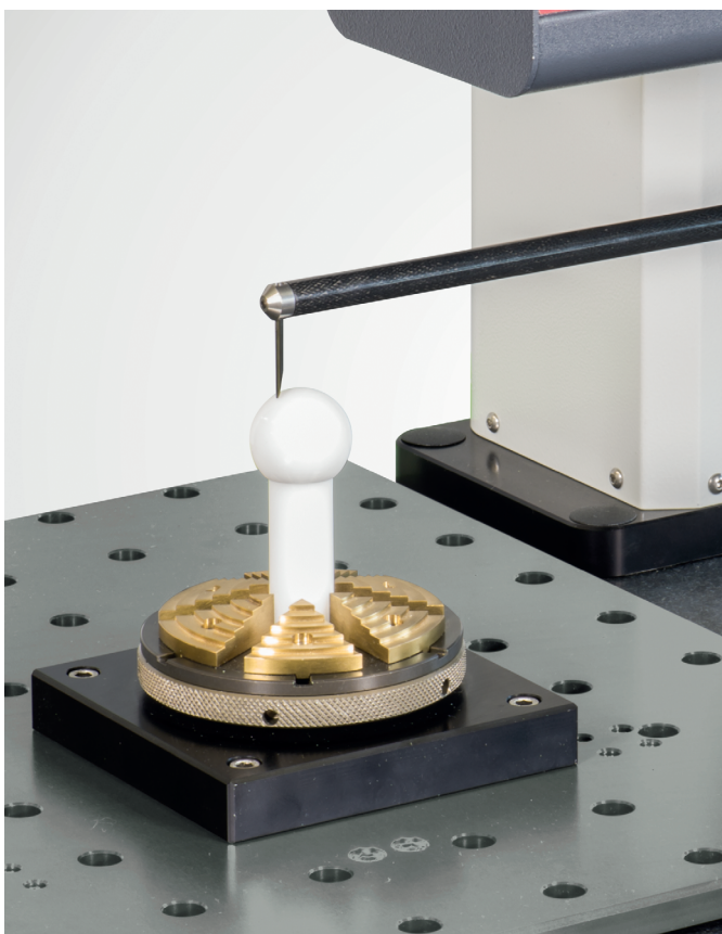
Mandrin – par exemple pour serrer des prothèses de hanches
