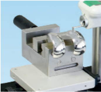
Mesure d'une prothèse de genou avec unité de palpation MarSurf RD 18 et palpeur à patin PHTR-100
