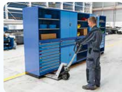
Etape 3 Placement du module au moyen d'un socle pour transpalette integre
