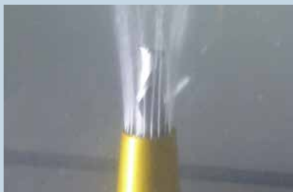
Système de douilles – refroidissement inefficace, fluide lubrifiant n'accède pas les arrêtes de coupe Riduzione con ugelli – raffreddamento inefficiente, il liquido refrigerante non giunge fino al tagliente
