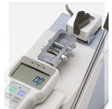
Configuration CW-500N + CH-500N sur banc d'essais horizontal
