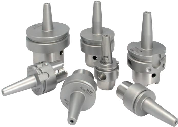
Nos mandrins de frettage sont utilisés sur des machines d'usinage pour bois et métaux équipés d'outils rotatifs. Les mandrins de frettage utilisent la dilatation thermique pour serrer l'outil. Les domaines d'application de ces dispositifs de serrage comprennent les opérations de fraisage diverses, l'usinage par enlèvement de copeaux et l'usinage du bois, ainsi que les applications de perçage.
