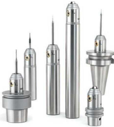
Les mandrins universels MICRO ont été développés spécialement pour le bridage de queues de faibles diamètres. Le serrage par mandrin de freinage n'est possible qu'à partir d'un diamètre de 3 mm. En raison de l'écrou-raccord, les mandrins porte-pinces possèdent un contour perturbateur plus important et l'arrosage est considérablement plus complexe.
