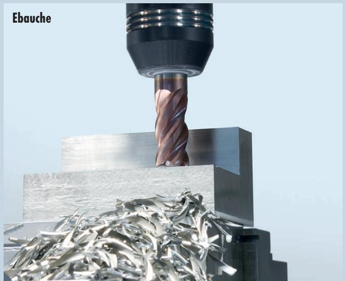
Le TENDO E compact est le premier porte-outil expansible hydraulique adapté aux enlèvements de copeaux importants : par ex. : jusqu'à 400 cm<sup>3</sup>/min dans de l'acier 42CD4\* \*valeur qui dépend la machine et de l'outil
