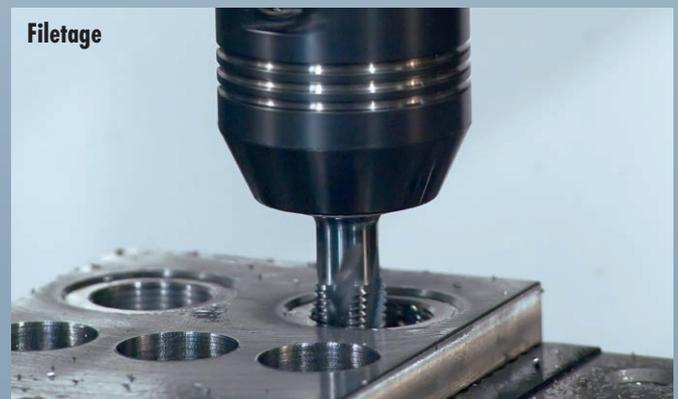
Avec un couple de serrage très élevé (jusqu'à 900 Nm en Ø20) et une excellente absorption des vibrations, le TENDO E compact est parfaitement adapté à la réalisation de filetages.
